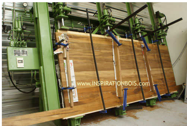
Fabrication d'un plan de travail panneauté - 3200*1050*42mm Lames larges (120mm) - Teck massif d'Asie
