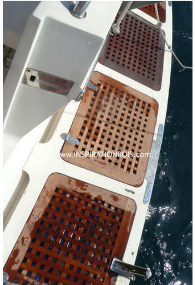
Remplacement de 3 des 4 caillebotis sur-mesure de la plateforme arrière d'un bateau sur base de gabarits - motor-yacht Princess
